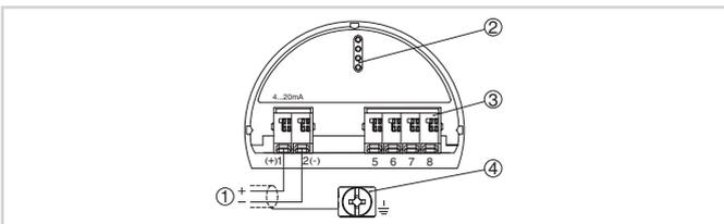
Отсек электроники и подключения (однокамерный корпус)
